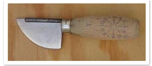
Figure 3 : Greffoir à lame courbe convexe utilisé pour les agrumes dans la communauté Valencienne en Espagne
